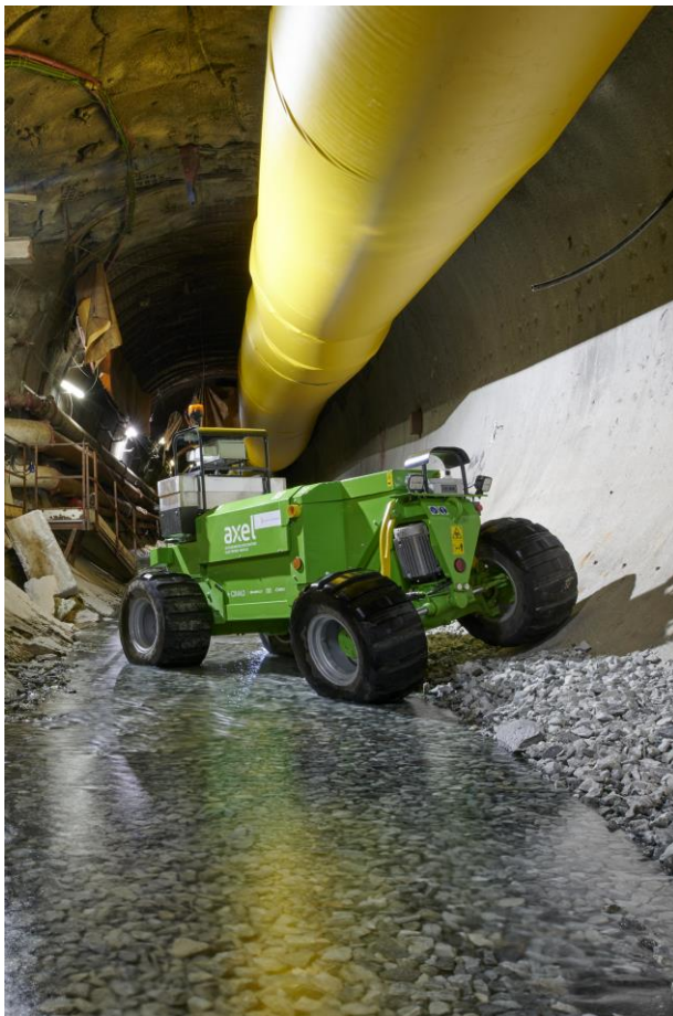
Ing. L. Brino - AXEL (Autonomous Exploration Electrified Vehicle), l' <<esploratore>> telecomandato del cunicolo geognostico della Maddalena
