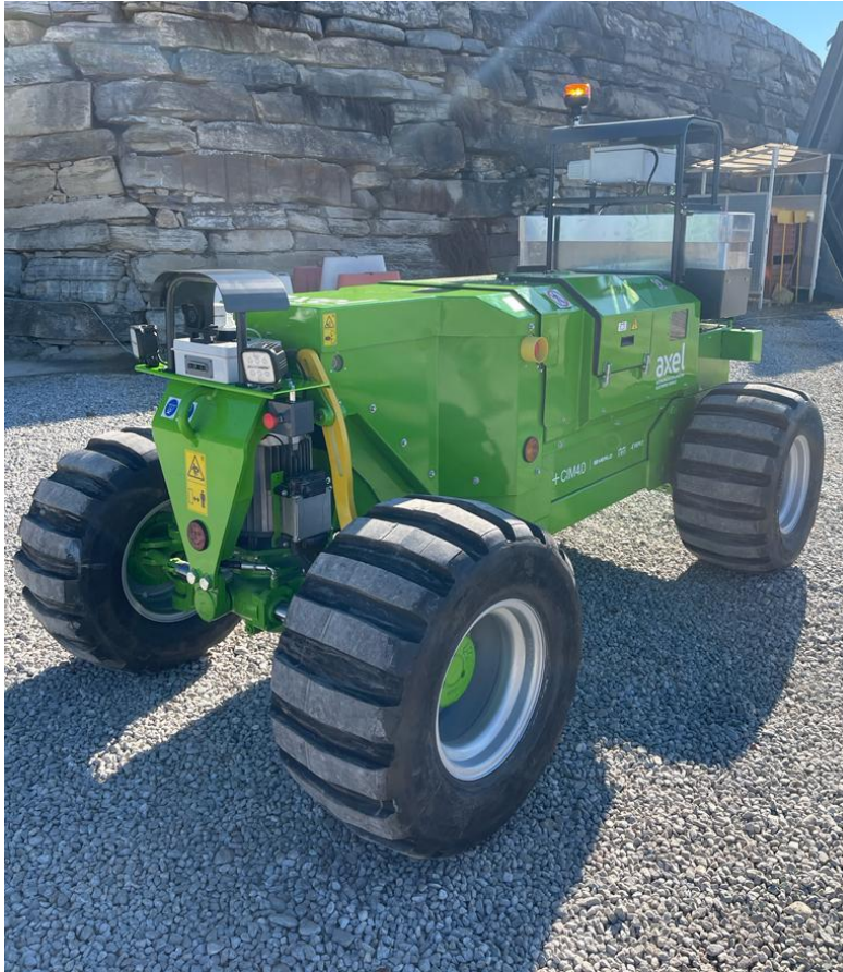
Ing. L. Brino- AXEL (Autonomous Exploration Electrified Vehicle), l' <<esploratore>> telecomandato del cunicolo geognostico della Maddalena
