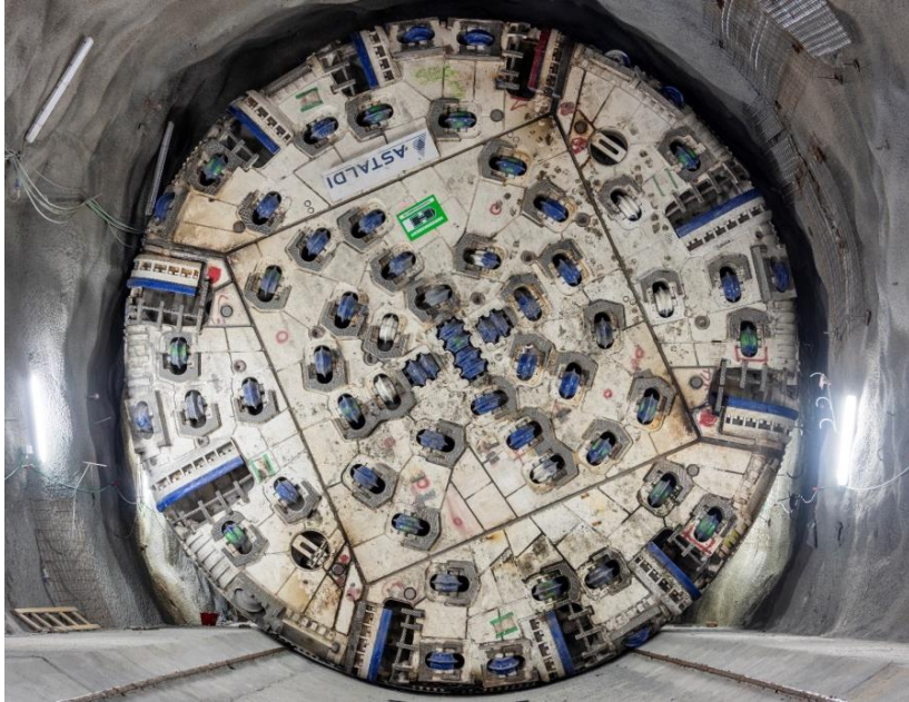
Lotto 61: TBM a doppio scudo S-1072 Virginia
